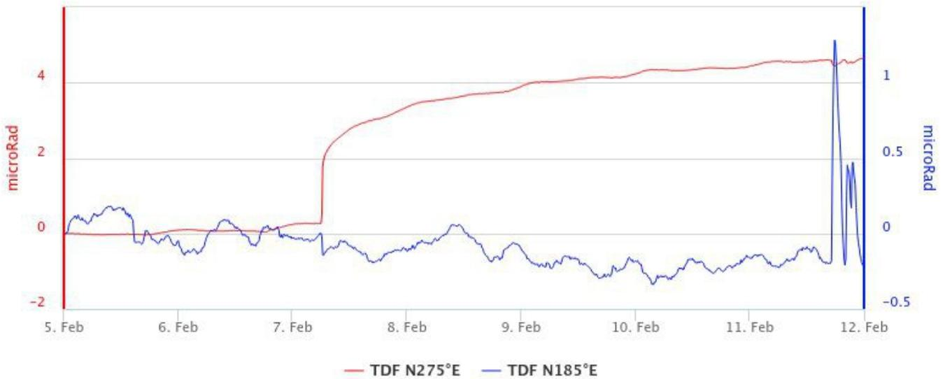
Fig. 5.2 Serie temporale delle componenti N275E e N185E della stazione clinometrica di TDF nel corso dell'ultima settimana.
