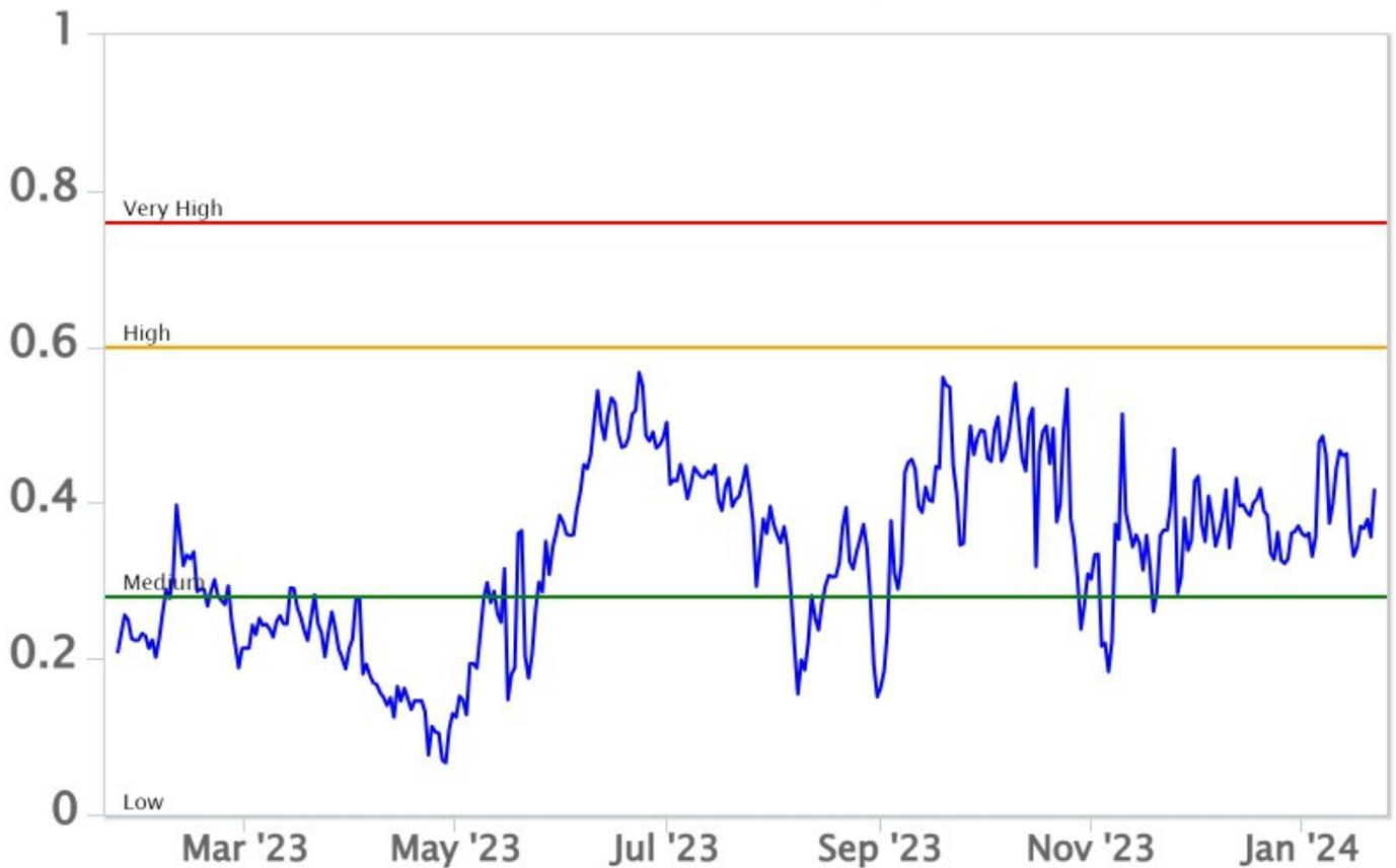
**Fig. 7.2** Curva normalizzata dei flussi complessivi della CO<sub>2</sub> esalante dal suolo registrati dalla rete EtnaGAS nell'ultimo anno (running average su base bi- settimanale).
