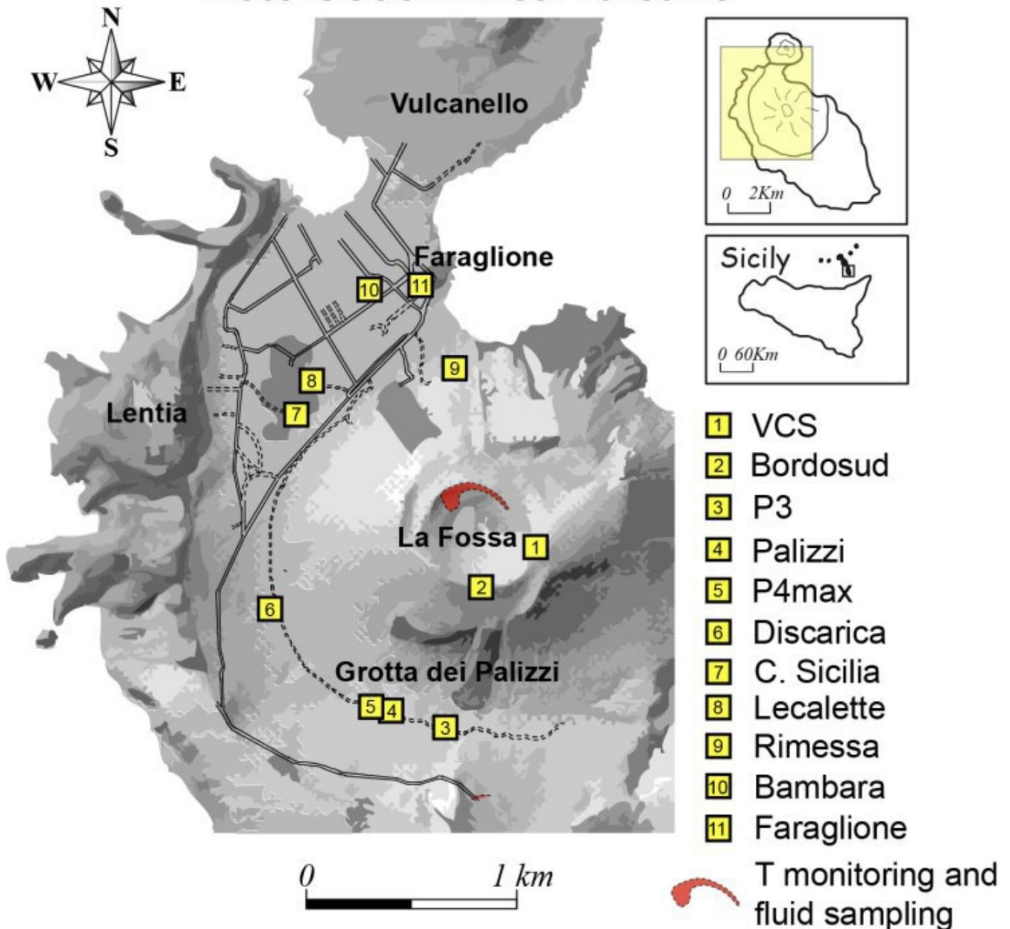
**Fig. 3.1** Ubicazione delle stazioni per la misura del flusso di CO<sub>2</sub> dai suoli, dei parametri chimico-fisici negli acquiferi termali, delle temperature di emissione delle fumarole, come indicato in legenda. Il settore evidenziato in rosso include le principali fumarole di alta temperatura (F0, F11, F5, F5AT e FA) e i siti di monitoraggio termico (F5; F5AT1; F5AT2; versante interno).
