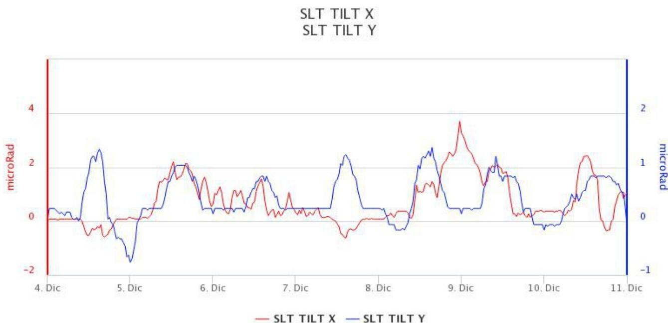
Fig. 12.1 Serie temporale delle componenti Radiale (X) e Tangenziale (Y) del clinometro di SLT, nel corso dell'ultima settimana.
