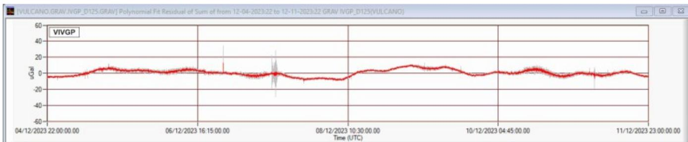
**Fig. 13.1** Segnale gravimetrico registrato nella stazione VIVGP dalle 22:00 UTC del 04 alle 23:00 UTC dell'11 dicembre 2023. In grigio il segnale acquisito al secondo; in rosso il segnale mediato al minuto. I dati sono corretti per gli effetti della marea terrestre e della deriva strumentale.
