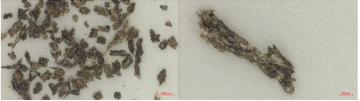
**Fig. 9.1** immagini al microscopio ottico ricostruite in 3D del campione costituito principalmente da sideromelano, preso a Petrulli.
