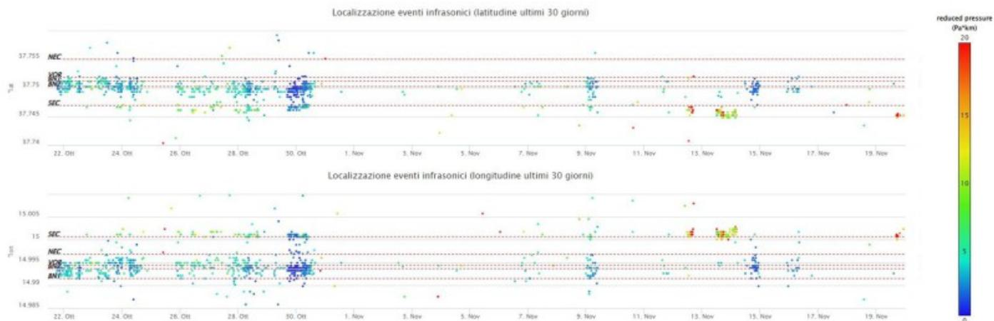
**Fig. 5.1** Andamento temporale dei parametri di localizzazione (longitudine e latitudine) degli eventi infrasonici localizzati nell'ultimo mese (SEC= cratere SE; VOR = cratere Voragine; NEC = cratere NE; BN1 = cratere 1 Bocca Nuova; BN2 = cratere 2 Bocca Nuova). A destra nel grafico, il colore dell'indicatore è funzione dell'ampiezza degli eventi.
