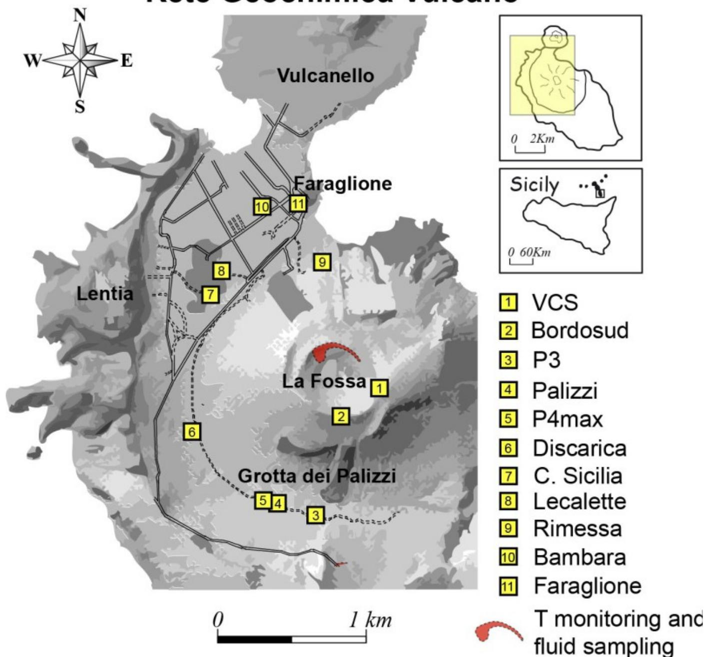
**Fig. 3.1** Ubicazione delle stazioni per la misura del flusso di CO<sub>2</sub> dai suoli, dei parametri chimico-fisici negli acquiferi termali, delle temperature di emissione, come indicato in legenda. Il settore evidenziato in rosso include le principali fumarole di alta temperatura (F0, F11, F5, F5AT e FA) e i siti di monitoraggio termico (F5; F5AT1; F5AT2; Versante interno).
