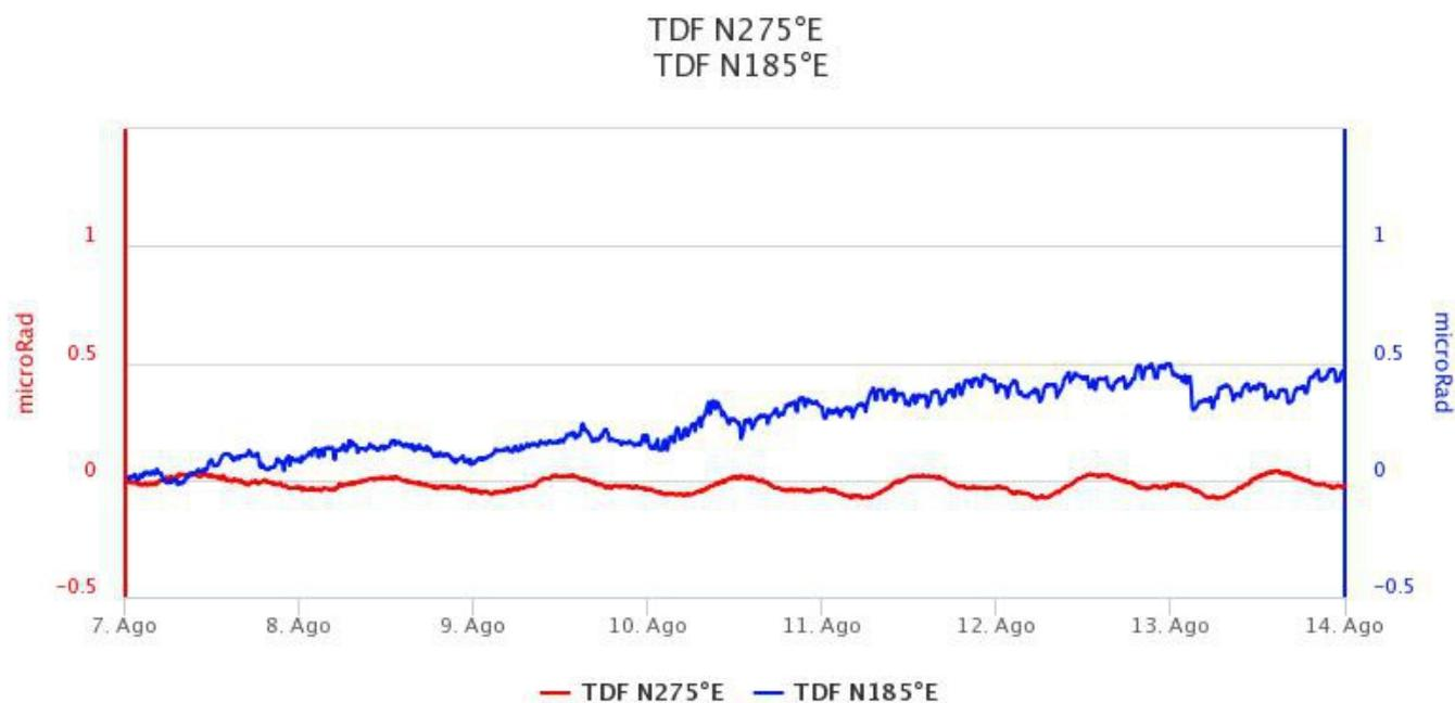
**Fig. 5.2** Serie temporale delle componenti X e Y del clinometro di Timpone Del Fuoco (TDF) nell'ultima settimana.
