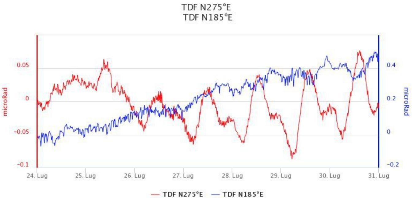
Fig. 5.2 Serie temporale delle componenti X e Y del clinometro di Timone Del Fuoco (TDF) nell'ultima settimana.
